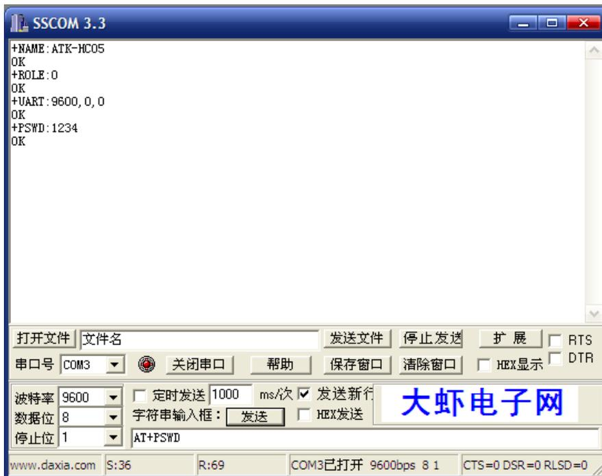
图 2.2.3.1 ATK-HC05 蓝牙模块部分配置查询
